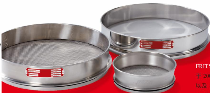
FRITSCH 优点：通用的支撑盘适用于 200、300、315、350、400 和 450mm 以及 8、12、16 或 18" 的筛子。筛盘符合 ISO 3310-1 和 ASTM E-11-1995 规定，孔径 20  $\mu\text{m}$  至 125 mm 之间。
