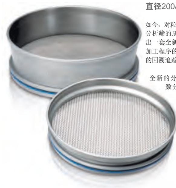
如今，对粒径分析工艺的要求不断地提高。这一点在ISO 3310中得到了反映。这一新的标准对分析筛的质量提出了更高的要求。为了使我们生产的分析筛适应新的要求，RETSCH开发出一套全新的生产工艺，保证了在以往的分析筛生产加工中所不能达到的质量和稳定性。加工程序的物流供应体系确保可以对所使用的全部加工物质和原材料进行完整的、无缺陷的回溯追踪。
