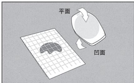
**10** 使用压板凹面底朝下，放置在上层膜中央处。
