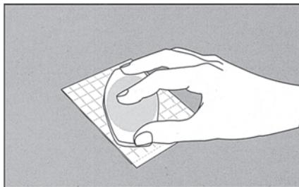
**11** 轻轻的压下，使样液均匀覆盖于圆形培养面积上，切勿扭转压板。
